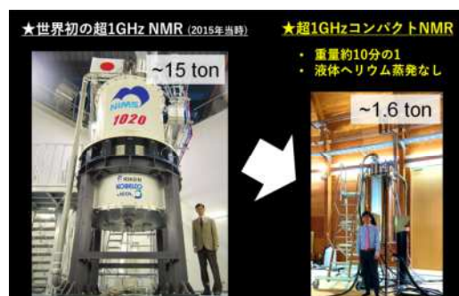
世界初の超 1GHz の NMR 装置（2015 年）と、今回開発した超 1GHz コンパクト NMR 装置
